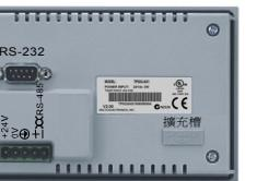
5-Pin 端子座 / 線徑：12-24 AWG / 扭力：4.5 lb-inch
